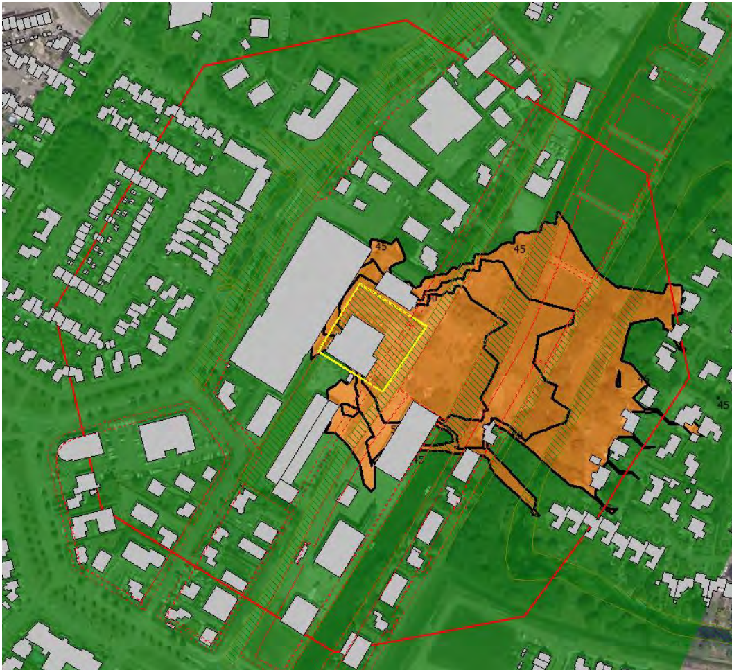
Figuur 6 rekenresultaten Tuyltel-machinery incl. bebouwing + 200 meter contour. Weergegeven zijn de 45 - 50 en 55 dB(A) contouren.
