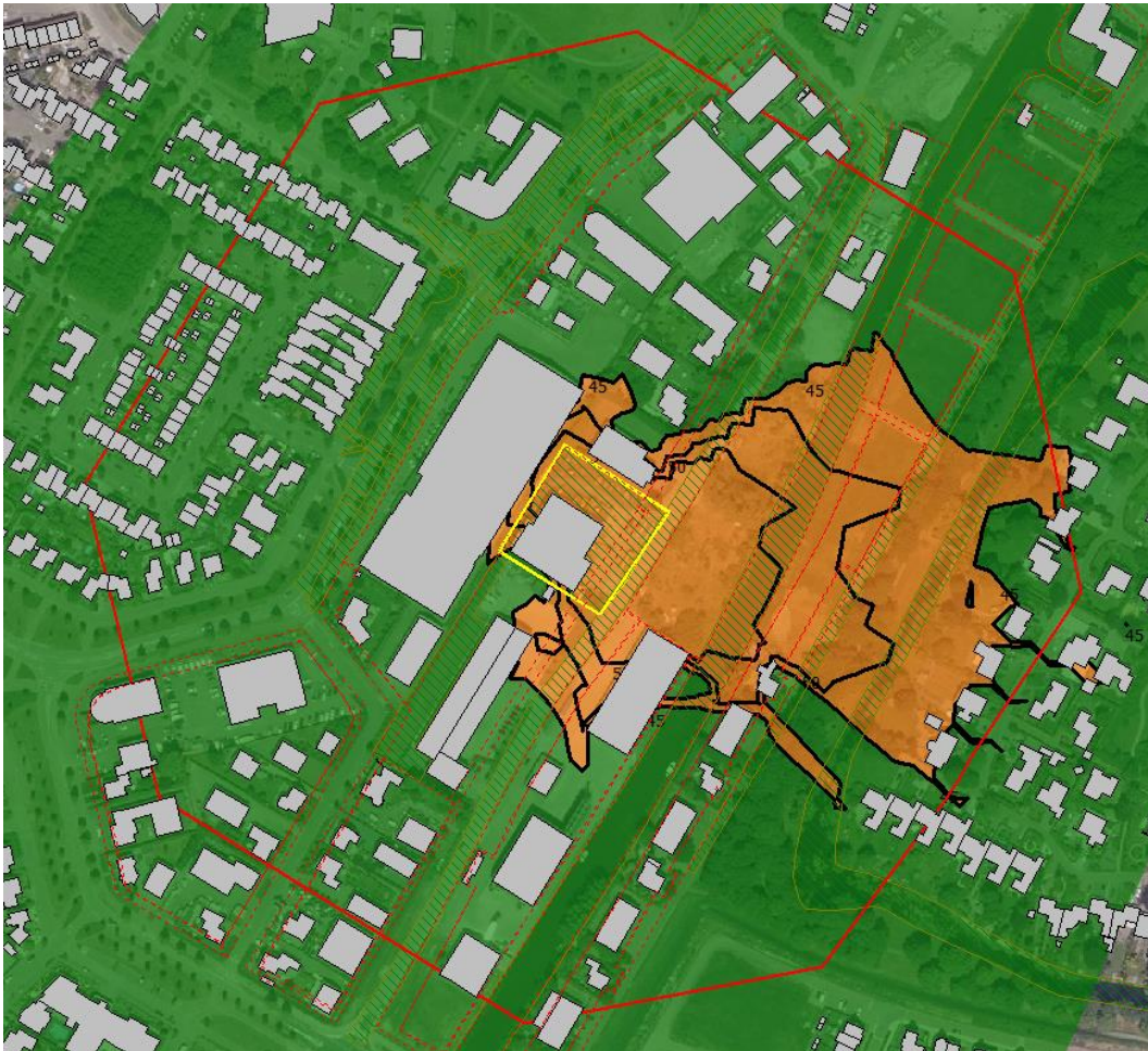
Figuur 6 rekenresultaten Tuytel-machinery incl. bebouwing + 200 meter contour. Weergegeven zijn de 45 - 50 en 55 dB(A) contouren.
